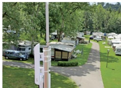
*WLAN-Systeme müssen optimal platziert werden, damit die komplette Abdeckung auf dem Gelände immer und überall gewährleistet ist.*
